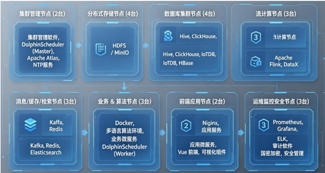
图 4 系统部署架构
