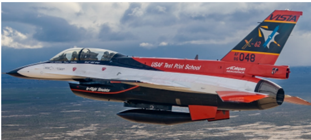
图4 X-62可变飞行模拟器测试飞机（VISTA）在爱德华兹空军基地上空飞行
